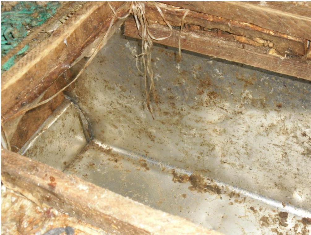
Figure 3 – Cale isotherme artisanale en mauvais état et sale
