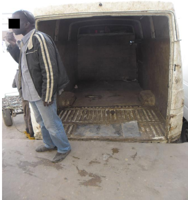
Figure 14 - Exemple de mauvaise pratique : véhicule de transport inadéquat (sale, impossible à nettoyer convenablement, non isolé)
